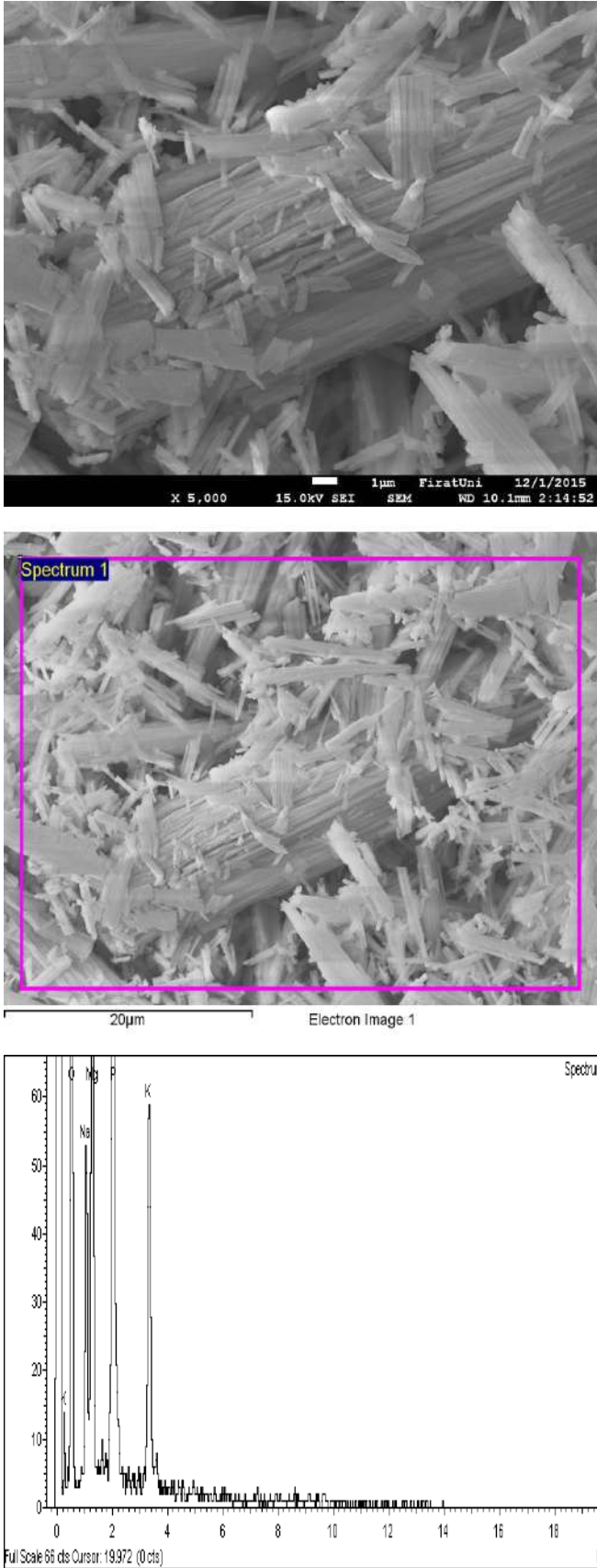
Şekil 8. Elde edilen K-struvitin SEM görüntüsü ve EDX değerlendirilmesi.
