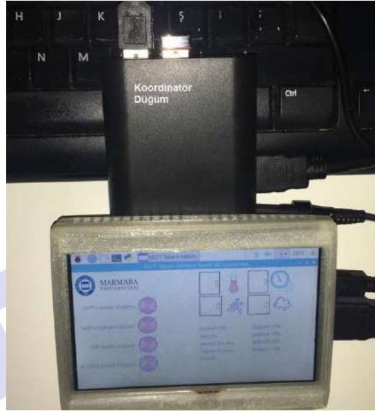
Şekil 3.5. Koordinatör düğümün dokunmatik ekran ile entegrasyonu
